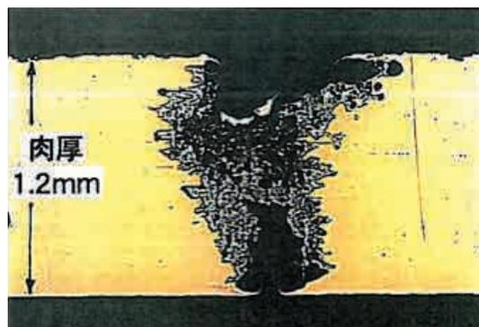
写真 1. 直管部の断面状況
